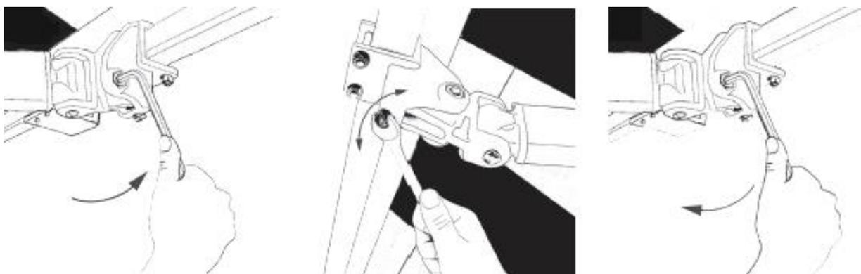
16) Après avoir modifié l'angle d'inclinaison, il faut penser à modifier la position du support du tube d'enroulement.
