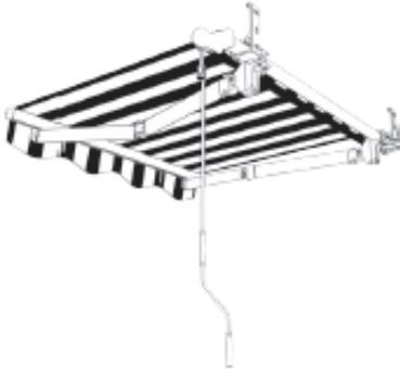
13) À l'aide d'un niveau à bulle, vérifiez que les bras se plient en un seul plan.
