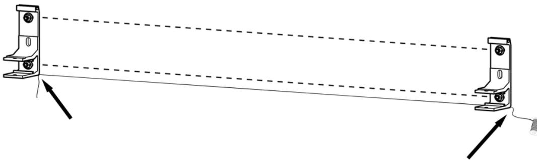
10) Fixez le store aux supports muraux de manière à ce que la structure du store (cassette) soit enfoncée le plus possible (attention - avant de fixer le store, vérifiez la linéarité des supports muraux - la surface du mur doit être d'épaisseur égale à l'endroit de la fixation).
