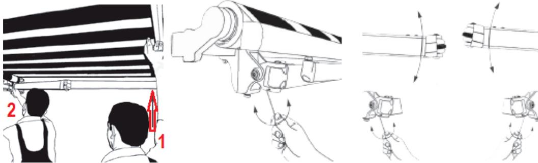
15) Pour modifier l'angle d'inclinaison du store, il est nécessaire de : 1) déployer complètement le store, 2) soutenir la barre frontale à la place du bras réglable, 3) à l'aide d'une clé, successivement dévisser (augmenter l'angle d'inclinaison) ou visser (diminuer l'angle d'inclinaison) les vis de réglage du support de bras, puis resserrer la vis.
