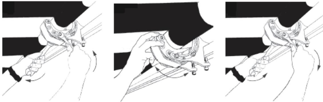
17) Ajustez les demi-anneaux du support du tube d'enroulement conformément aux instructions illustrées (ci-dessous).
